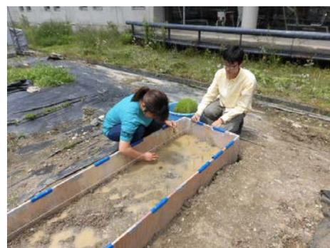
プラスチック被覆肥料の流出実験
