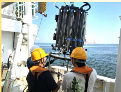
水質調査装置(CTD装置)を海に投入するところ
