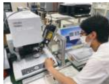
顕微FTIR装置を用いて分析 宝亀 稜さん（環境情報学部3年生）
